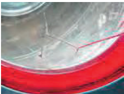
Een gebarsten voorruit met een begin van scheurvorming
