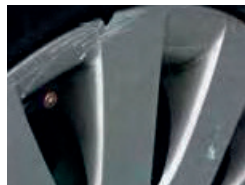
Zichtbare vervorming aan een velg of wioldop
