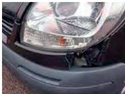
Gebroken, gebarsten, vervormde of losgelaten bumpers, grille of stootstrips
